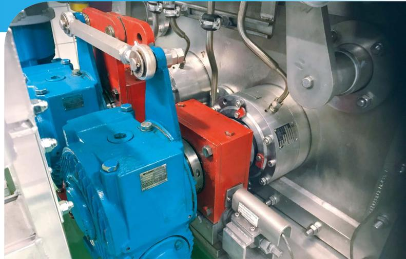
Walzentrockner mit seitlichem Abtrieb der Walzen
