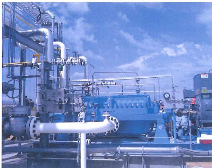
Sulzer Ethanpumpe in einer NGL-Fraktionierungsanlage in Houston, Texas. Pumpe und Dichtungen laufen seit der Umrüstung auf die innovative Dichtungslösung DF-DGS6 im Jahr 2011 störungsfrei
