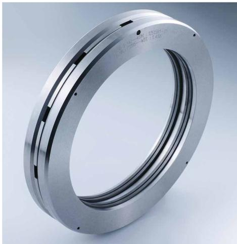
Бесконтактные углеродные кольца – это сегментированные кольца, которые удерживаются по наружному диаметру кольцевой пружиной. Заданный радиальный уплотнительный зазор обеспечивает бесконтактную эксплуатацию. Низкий расход газа. Уплотнение надежно удерживает масло. На практике оно продемонстрировало прочность и надежность даже в случае кратковременных внештатных воздействий.
