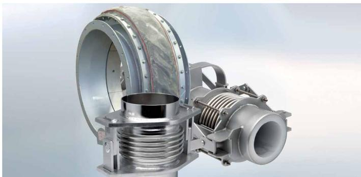
Они используются в качестве гибких соединений в воздуховодах, вентиляционных шахтах и трубопроводах для компенсации колебаний давления и температуры, вибрации и смещений в местах соединений. Кроме того, они должны надежно герметизировать и быть устойчивыми к воздействию технологических сред. Компенсаторы, выполняемые по специальным запросам в соответствии со специфическими условиями и изготавливаемые из мягкого материала, металла или резины, имеют высочайшее качество.
