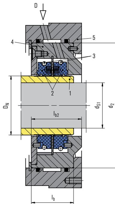
Les étanchéités carbone se caractérisent par de très faibles taux de fuite, aussi bien en statique qu'en dynamique. En statique, les segments carbone sont comprimés sur l'arbre, d'où une fuite minimale. En dynamique, la face profilée au diamètre intérieur de l'anneau segmenté, pour des vitesses de glissement > 10m/s (33fms), assure le décollement aérodynamique.
