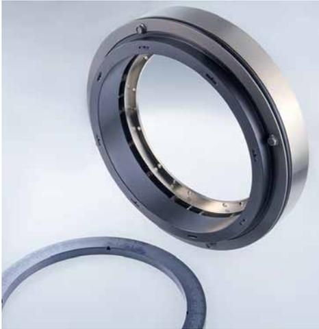
Les garnitures de la série NF941 sont utilisées dans des compresseurs à vis pour des applications spécifiques. Ce sont des garnitures hybrides, utilisables aussi bien comme étanchéité aérostatique ou aérodynamique. Le gaz de barrage est dirigé, via des perçages dans le grain coulissant stationnaire, directement entre les faces de frottement, la séparation des faces de frottement est réalisée par l'intermédiaire de rainures gaz spéciales.
