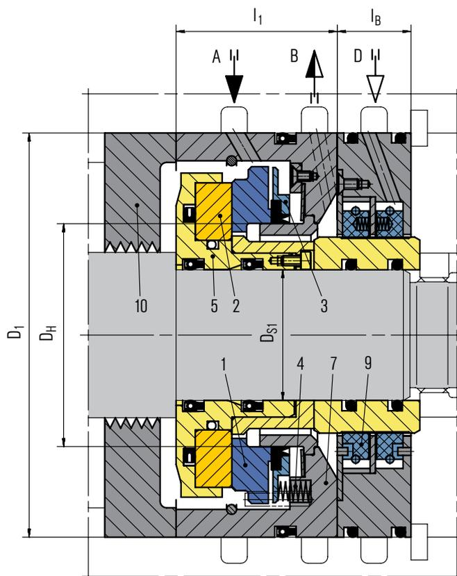
La garniture de compresseur reconnue pour les hautes pressions et températures extrêmes, utilisée par exemple dans la réinjection de gaz sur les plateformes pétrolières. Des caractéristiques spécifiques innovantes permettent d'utiliser cette garniture à très hautes pressions en toute sécurité. L'emploi de joints U-Cap et de joints dynamiques spéciaux élargit de façon importante la plage d'utilisation de cette garniture.
