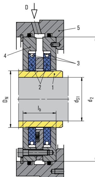
Les bagues carbone sans contact sont des bagues segmentées qui sont maintenues sur le diamètre extérieur par un ressort annulaire. Un jeu d'étanchéité radial défini assure le fonctionnement sans contact. La consommation en gaz est modérée. Cette garniture assure la séparation de l'huile, elle est robuste et fiable même dans des conditions difficiles.
