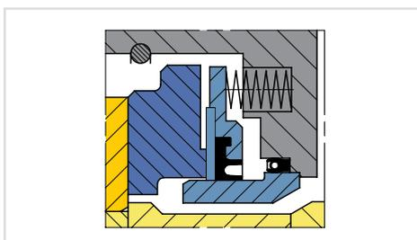
Les composants principaux de l'élément dynamique de la PDGS sont en carbure de tungstène, matériau extrêmement stable et résistant aux déformations pour maîtriser de manière optimale le jeu fonctionnel (extrusion) dans tous les états de fonctionnement. La conception particulière du joint à lèvres dynamiques en polymère assure un déplacement axial aisé et un fonctionnement sans usure.
