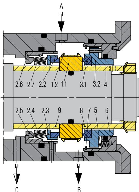
Garniture mécanique huile pour compresseurs à vis. Cette étanchéité d'arbre se caractérise par un montage simple, une longueur de montage courte, un fonctionnement en toute sécurité, même en cas de modification des pressions, et des performances fiables à hautes et basses températures
