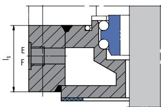
Bride de refroidissement, également utilisable comme bride de réchauffage ( $t_{\max} = 250 \text{ °C (482 °F)}$ ).
