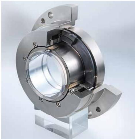
La garniture gaz pour les turbines à vapeur mono-étagées. Un soufflet métallique sécurise le fonctionnement à hautes températures. Les fuites de vapeur d'une TDGS correspondent à une fraction de celles d'un anneau carbone, les deux solutions génèrent non seulement des économies d'énergie, mais aussi un meilleur rendement de la turbine. L'huile des paliers n'est plus polluée par la condensation de vapeur, d'où une augmentation de leur durée de vie et une réduction des coûts de maintenance.
