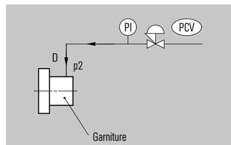
Schéma de raccordement et d'instrumentation d'une CobaSeal (alimentation en gaz de séparation régulé en pression).
