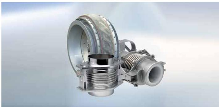
Les compensateurs de dilatation assurent la flexibilité requise par les tuyauteries véhiculant tous types de liquides et gaz. Ils permettent de palier aux éventuels désalignements, de reprendre les mouvements liés au fonctionnement des machines et/ou aux dilatations thermiques, etc...
